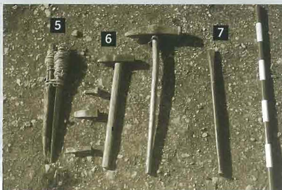
1. Aixada de collir pedra. 2. Perpal; 3. Mall; 4. Tascons. 5. Corda; 6. Martell; 7. Perpalina.
